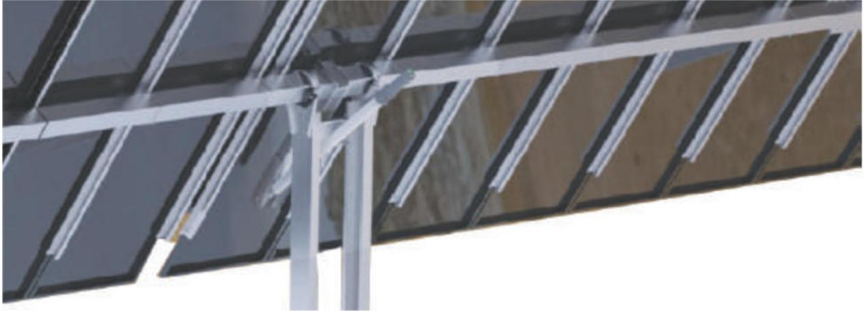
***La forma de instalación sobre el suelo, se realizará mediante hincado, con una profundidad aproximada de entre 1.5 y 2 metros. Esta estructura no lleva asociada a su instalación ningún otro material como el hormigón, siendo su instalación idéntica a la que se realiza en los quitamiedos ubicados en las carreteras.***
